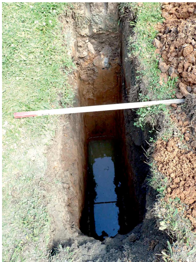
Foto 2. Realizace nálevové vsakovací zkoušky v kopané sondě KS1.
